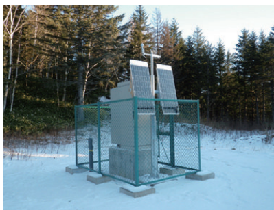
●北海道の山中に設置された、震動モニタリング調査用の計測器
